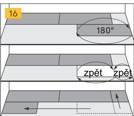
*Poznámka: Nikdy nezkoušejte lamelu do zaklikávacího systému pomocí dřevěné doklepávací desky zatlouct jedním rázem*
